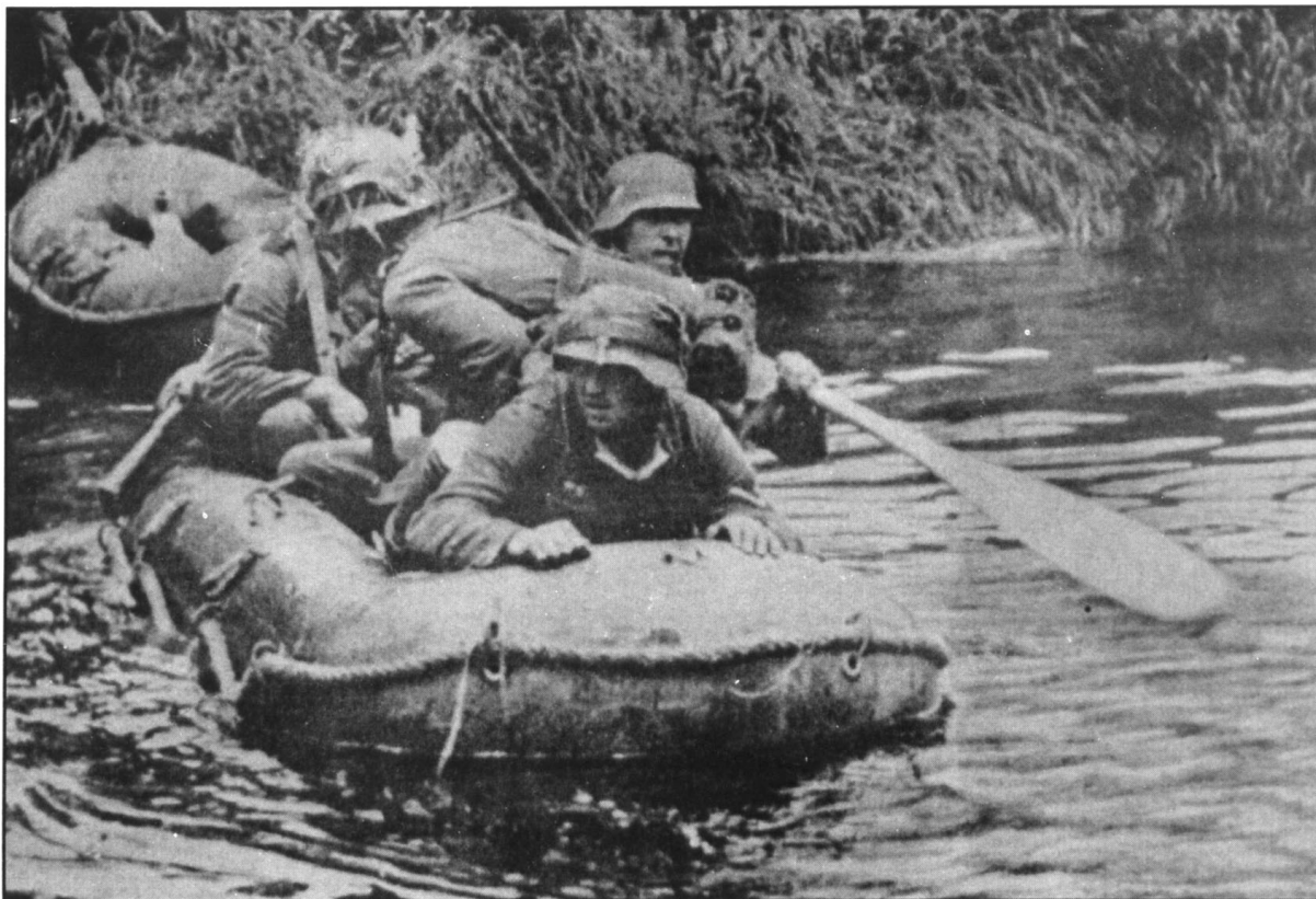
Для переправы часто использовались надувные лодки. Малая лодка была 3 метра длиной и весила около 50 кг. Она могла перевезти трех человек или 300 кг груза.
