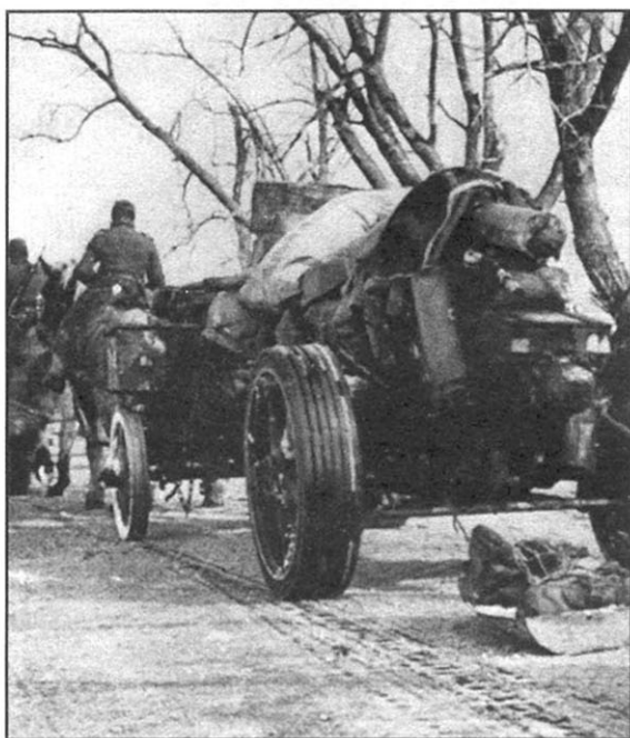
Лишенная ствола тяжелая гаубица во время транспортировки
