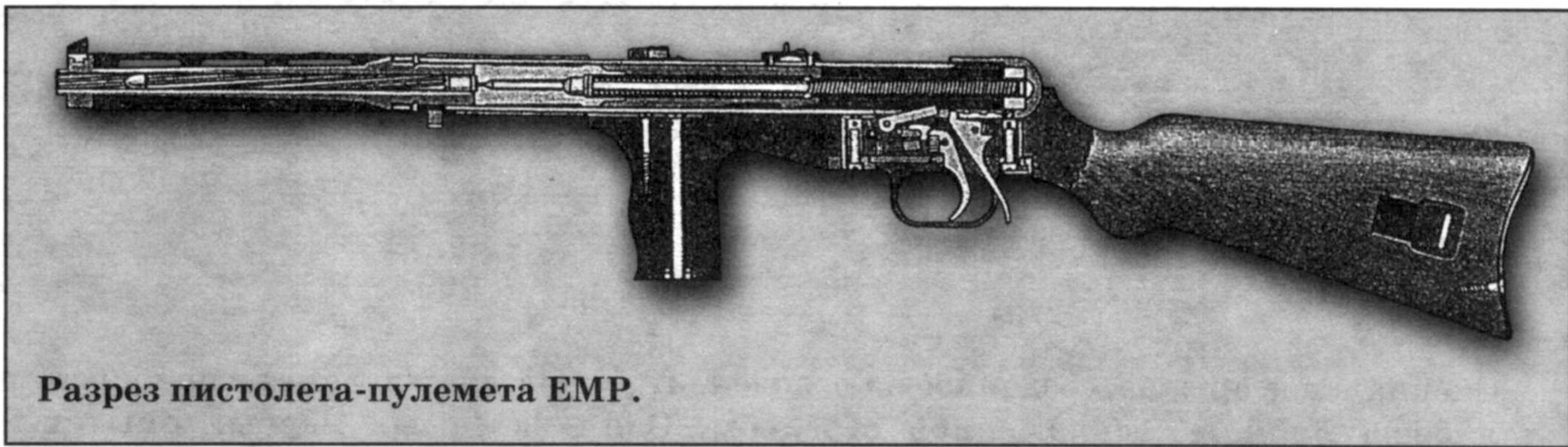
Рукоятка, заведенная в коленчатый вырез в задней части затворной коробки, надежно удерживала затвор в заднем положении. Так решался вопрос предохранения от случайных выстрелов в большинстве пистолетов-пулеметов того времени.
