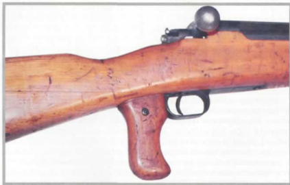
Пистолетная рукоятка управления огнем существенно удуришила прицельную стрельбу из 13-мм противотанкового ружья Mauser M.1918
