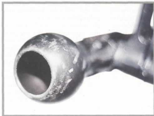
Однокамерный дульный тормоз закрытого типа 7,92-мм ПТР PzB M.SS.41
