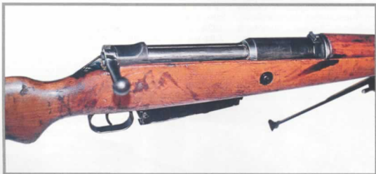
Открытый затвор 7,92-мм противотанко- вого ружья системы Морошека PzB.35 (p)
