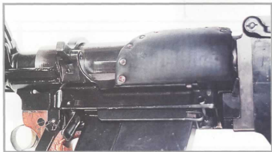
Для удобства стрельбы на кожане 7,92-мм противотанкового ружья PzB M.SS.41 слева закреплен упор для щеки, обшитый кожей
