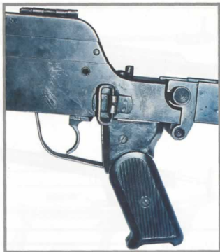
Спусковой рычаг ПТР PzB.39, совмещенный с pistolетной рукояткой управления огнем
