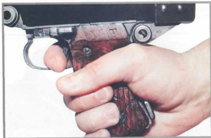
Пистолетная рукоятка управления огнем 7,92-мм противотанкового ружья PzB.38. Над спусковой скобой расположен флажок неавтоматического предохранителя. В нижней части рукоятки смонтирован рычаг автоматического предохранителя
