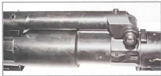
Узел крепления кожуха возвратной пружины 20-мм противотанкового самозарядного ружья "Солотурн" PzB.41
