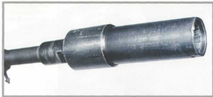
Мортирка 30-мм противотанкового гранатомета GrV.39
