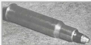
28/20-мм унитарный выстрел "Patrone 8202" к автоматической противотанковой пушке Маузер МК. 8202
