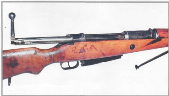
Открытый затвор 7,92-мм противотанко- вого ружья системы Морошека PzB.35 (p)
