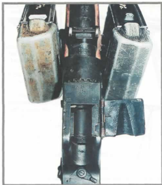
Полуавтоматический клиновидный затвор ПТР PzB.39 в положении для заряжания патрона
