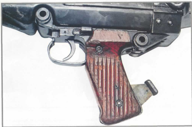
Пистолетная рукоятка управления огнем 7,92-мм противотанкового ружья PzB.38. Над спусковой скобой расположен флажок неавтоматического предохранителя. В нижней части рукоятки смонтирован рычаг автоматического предохранителя
