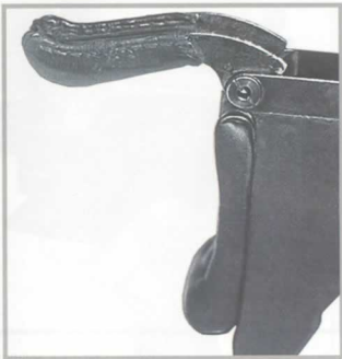
Пример с откидным нагнелчком 7,92-мм противотанкового ружья PzB.M.SS.41
