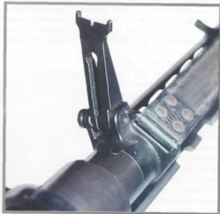
Прицельные приспособления 7,92-мм противотанкового ружья PzB M.SS.41 состоит из откидных целика и мушки, рассчитанного на дальность 500 м
