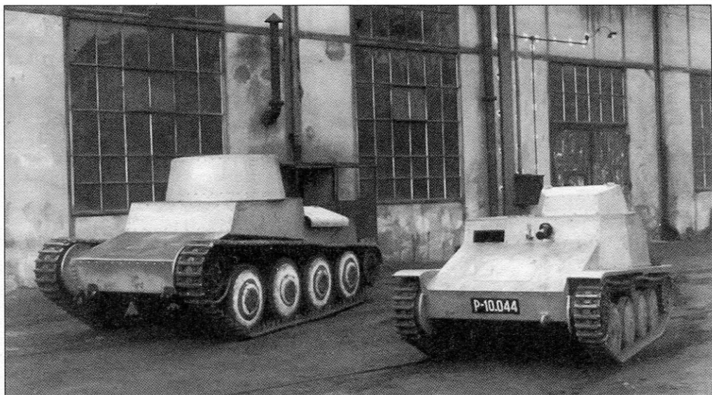
Прототипы танка TNH (слева) и танкетки AN-IV (справа) во дворе фирмы SKD. Сентябрь 1935 года. Обе машины изготовлены из простой стали
