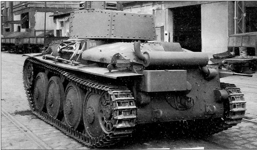
Танк Pz. 38(t) Ausf. G – вид с кормы. Хорошо видны глушитель и размещенный под ним кожух прибора дымопуска
