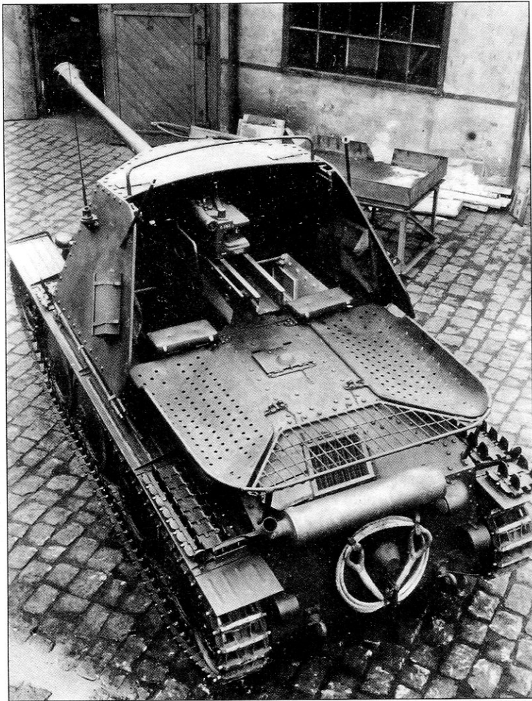
Вид сверху на боевое отделение САУ Marder III Ausf.H. Хорошо видны сиденья членов экипажа и откидные элементы полка на крыше моторного отделения
