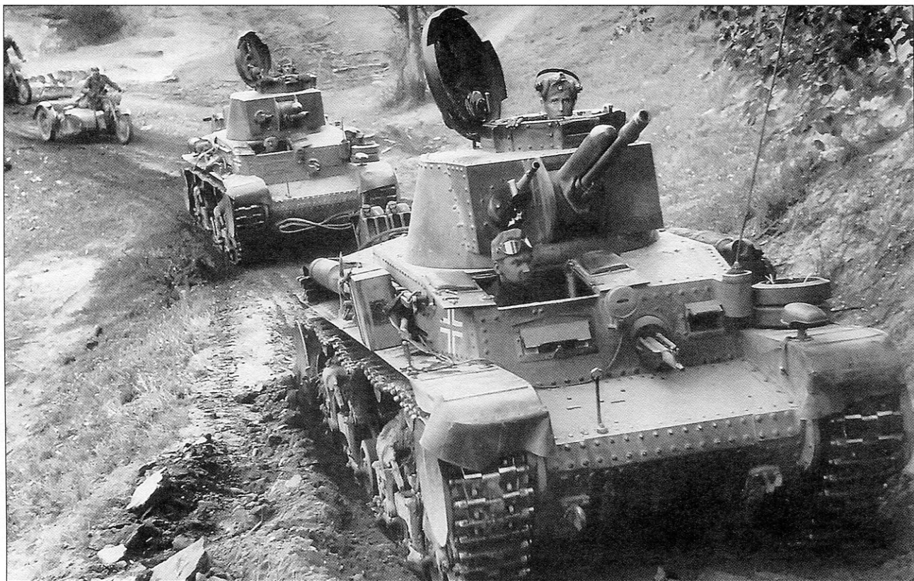
Колонна Pz.35(t). Восточный фронт, лето 1941 года. На левых надгусеничных полках машин хоро- шо видны светомас- кировочные фары Notek и запасные опорные катки
