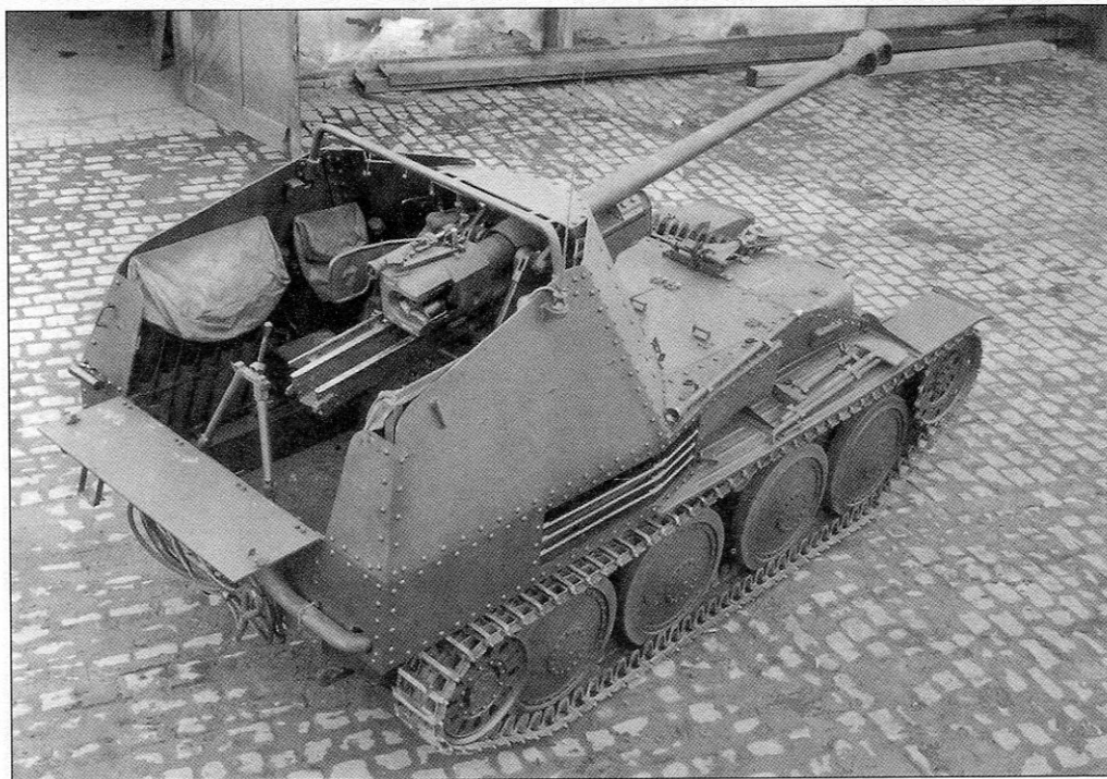
Истребитель танков Marder III Ausf. M. Кормовая стенка рубки откинута в горизонтальное, боевое, положение
