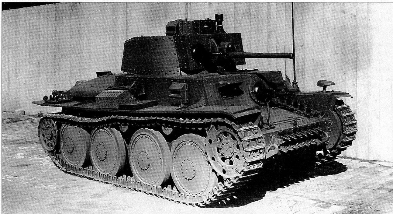
Легкий танк Pz. 38(t) Ausf. E или F во дворе завода фирмы BMM. Обращает на себя внимание массивная прямая лобовая плита корпуса
