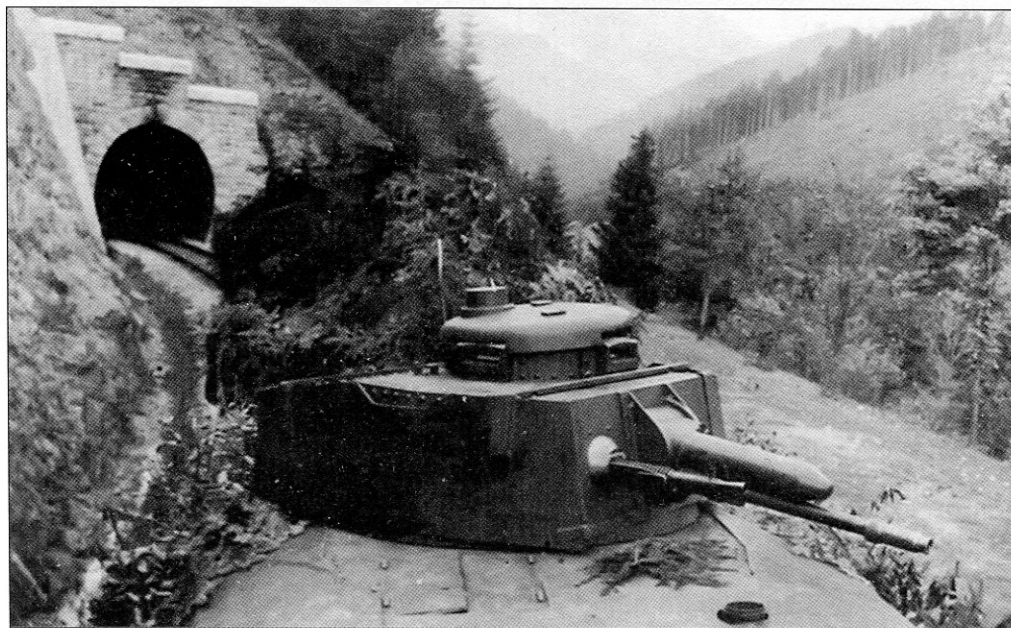
Некоторое количество башен, снятое с неисправных или переоборудованных танков Pz.35(t), после усиления брони использовалось на бронепоездах
