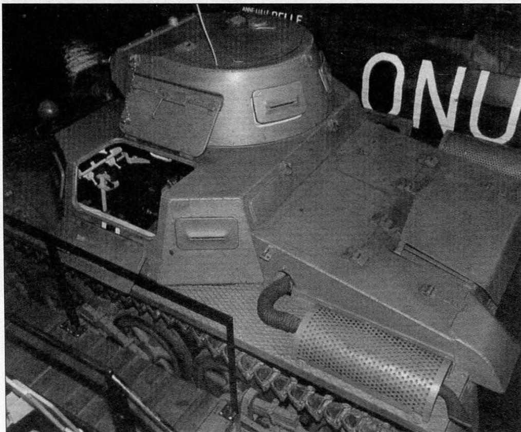
Вид сверху на Pz.I Ausf.A. Хорошо видны сетчатое ограждение глушителя и открытый посадочный люк механика-водителя
