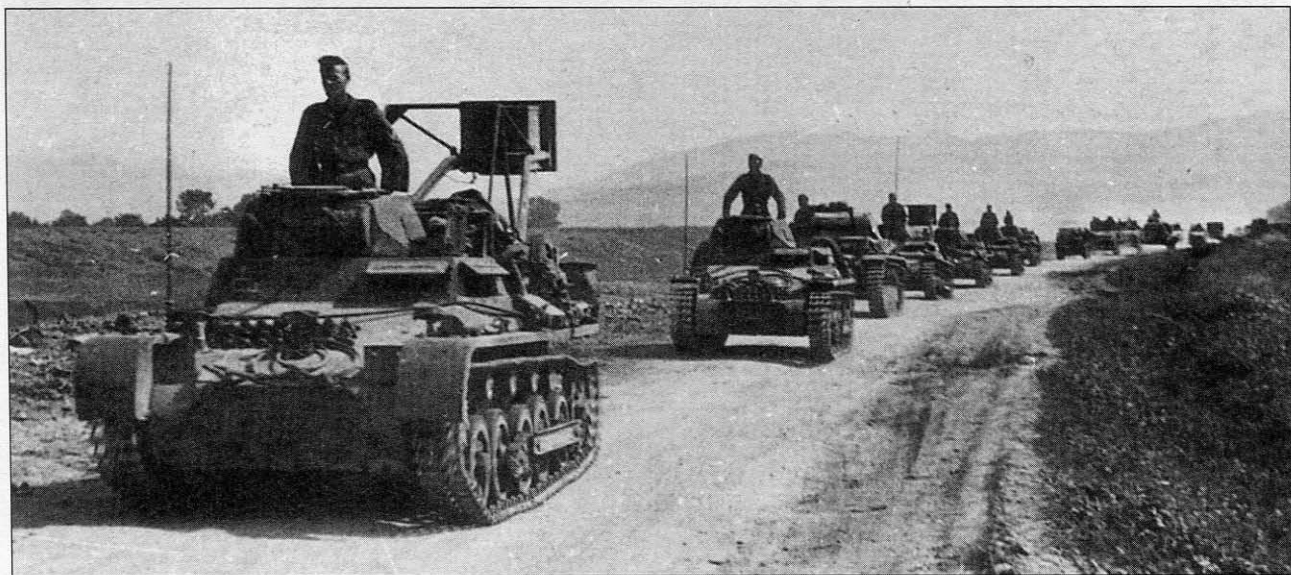
Колонна боевых машин 58-го инженерного батальона. Франция, май 1940 года. Во главе колонны — подрывная машина Ladungsleger I (второй вариант)
