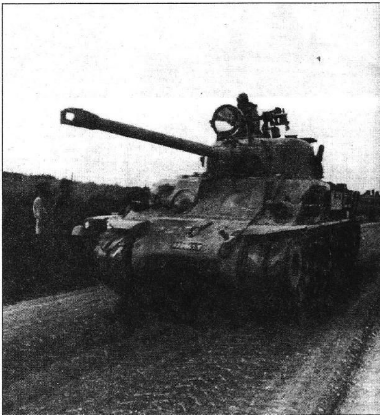
М51, движущийся на передовую, Сирия, 13 октября 1973 года. Обратите внимание на прожектор, смонтированный на башне рядом с 12,7-мм пулеметом. Поскольку сирийские командос действовали по преимуществу ночью, израильские танки оснащались прожекторами.
